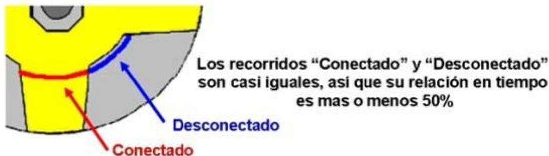
Si, en cambio, la escobilla ajustable se posiciona cerca del borde exterior del disco, entonces debido a la forma del brazo de cobre, el recorrido sobre la parte no conductora del disco es casi 3 veces mayor que el recorrido sobre la parte conductora de cobre, por tanto, en ese caso, la relación Conectado/Desconectado será mas o menos del 25%. Como la escobilla ajustable puede colocarse en cualquier sitio entre esos dos puntos, el "Ciclo de Trabajo" puede ajustarse entre el 25% y el 50%.
