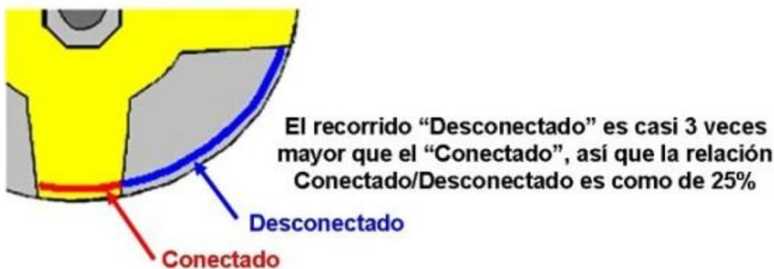
Las dos escobillas pueden estar en el mismo lado del centro del disco, o en lados opuestos como se en el ejemplo que muestran los diagramas anteriores. Un rasgo importante es que las escobillas tocan la superficie del disco en una posición que siempre está lejos del brazo de montaje de la escobilla, así que no ejerce ninguna tensión lateral sobre ella. El diámetro del disco es por lo general una pulgada (25 mm) o menos.
