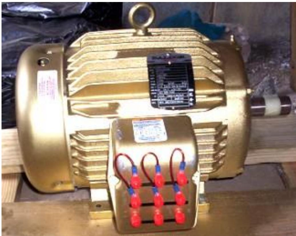
**Acabado externo del Cajetín de Conexiones luego de la modificación**
